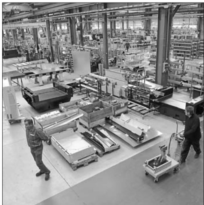
Blick in die Montagehalle: Bei Weeke werden die Bütfering-Maschinen auf einem Shuttlesystem hergestellt und nur einmal ausgerichtet.
